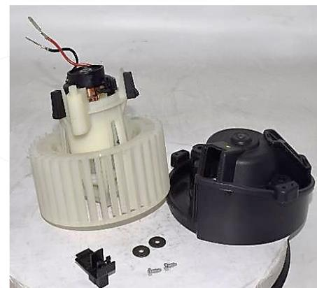
6) Sblocco delle 4 alette di fissaggio dell'alloggiamento motore ventola abitacolo
