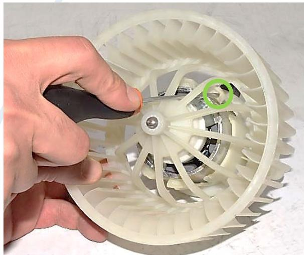
7) Rimozione alloggiamento motore ventola abitacolo
