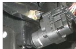
Inserire l'interruttore dentro il foro del corpo del pedale (posizione obbligata). Per fissarlo, l'interruttore deve essere ruotato verso destra fino allo scatto (circa 45°) ottenendo la definitiva posizione di assemblaggio.
