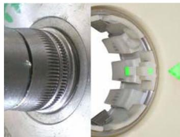
8) Montare il sensore nuovo con pressione uniforme, in modo da permettere l'aggancio di entrambi i dischi.
