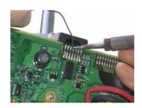
5) Allineare con cura i segni di riferimento, ruotando l'alberino quanto necessario. Togliere il sensore agendo nella parte inferiore con un cacciavite o un attrezzo analogo.
