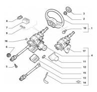
2) Smontare il coperchio della struttura e togliere l'anello elastico e il cannotto.
