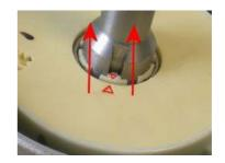
6) Prestare molta attenzione al nuovo sensore. La molletta di fermo deve essere perfettamente ortogonale alla struttura plastica in maniera da rendere solidali entrambi i "dischi" del sensore.
