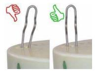
7) L'alberino possiede due ghiere assiali che lavorano in simbiosi con i due dischi del sensore. Verificare che i tre punti di riferimento del sensore siano perfettamente coincidenti, prima del montaggio.
