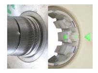
8) Montare il sensore nuovo con pressione uniforme, in modo da permettere l'aggancio di entrambi i dischi.
